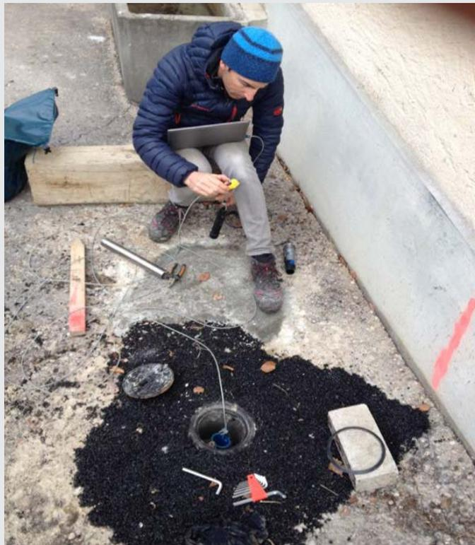
Récupération des mesures de hauteur d'eau, température et conductivité électrique au forage R7 dans le cadre de la surveillance des eaux souterraines en vue du projet de réhabilitation de l'usine hydroélectrique du Furcil (NE).
