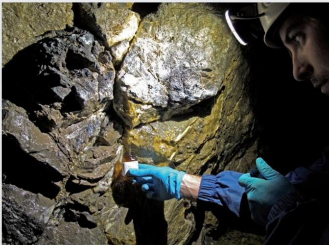
Prélèvement d'eau dans la galerie de captage de Bossy dans le cadre de la surveillance du multitraçage de juin 2020.
